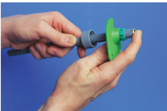
3. Schuif de BiTite grippring van de buis met de BiTite demontagewig. U kunt de ring hergebruiken als hij onbeschadigd is.
