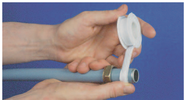
2. Gebruik PTFE-tape over de koperen klemring.
