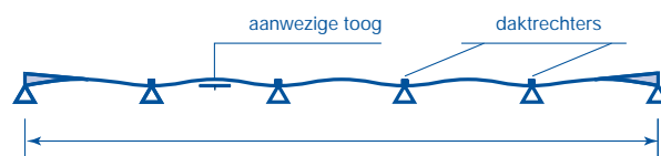
Afb. 3.4 Opvullen buitenste rand ten behoeve van een goed dakafschot.
